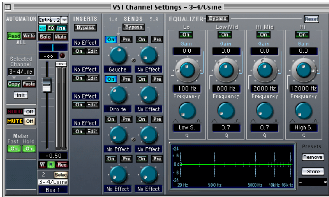
Fig. 3 Cette configuration est sans danger, puisque les boutons "Pre" des envois d'effets sont désactivés. Nous sommes donc en mode "post-fade": désactiver la piste revient à bloquer l'envoi aux effets.
