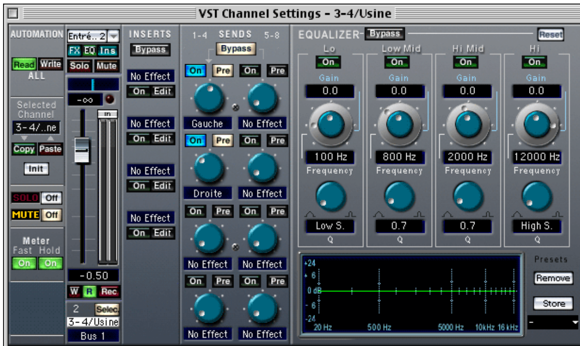
Fig. 4 Ici, pour parer au danger que représente le fait que l'envoi "Pre" est utilisé, on a utilisé la fonction "Bypass", qui désengage tous les envois d'effet. Ceci est confirmé par le fait que l'indicateur "FX" s'est éteint.
